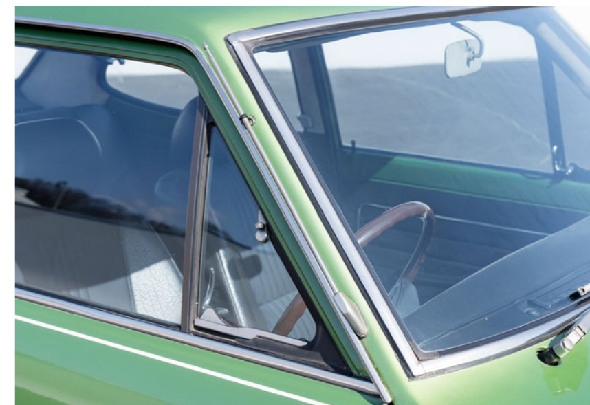
▲かつて国内外のクルマに多くみられた三角窓(1970年式日産「サニー(B110)」)
