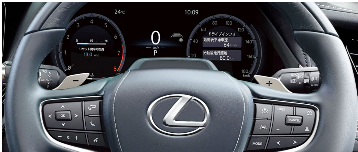
▲最近ではさまざまな表示をステアリングスイッチで切り替えるのが主流です
