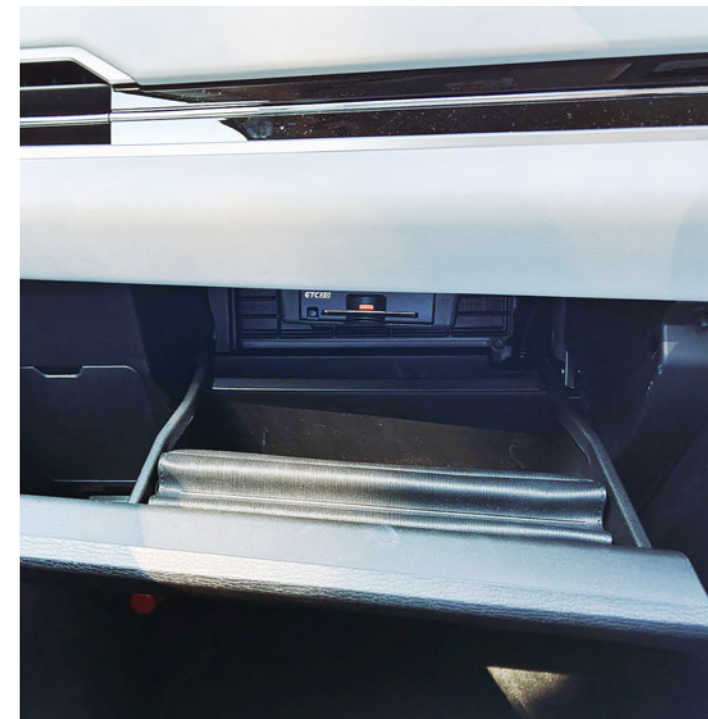
▲ETC車載機などはグローブボックスに収納されるようになりました
