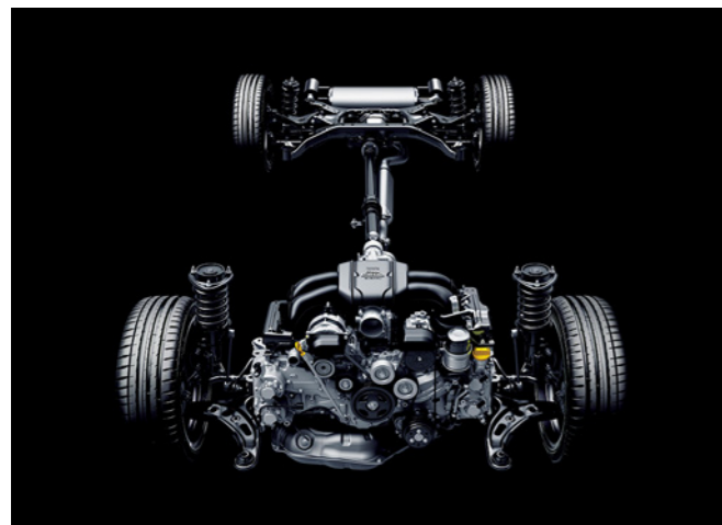
▲フロント(写真手前)のエンジンからの出力を、中央のプロペラシャフトを介して後輪(上)に伝えるFR方式。トヨタ「GR 86」
