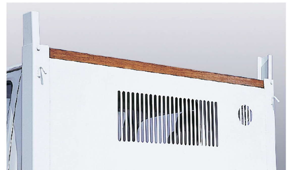
▲ ダンプの鳥居上部枕木/角出し
