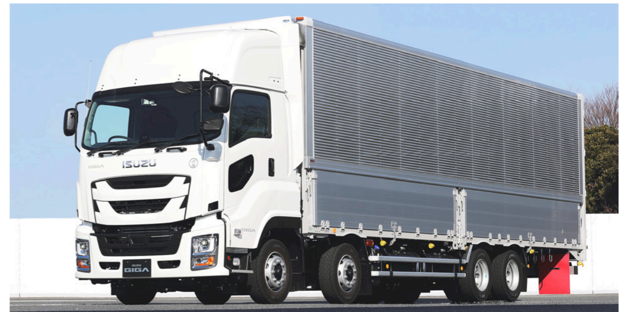
▲ 小径タイヤによって床面高を下げ、荷室容積を稼ぐ低床車
