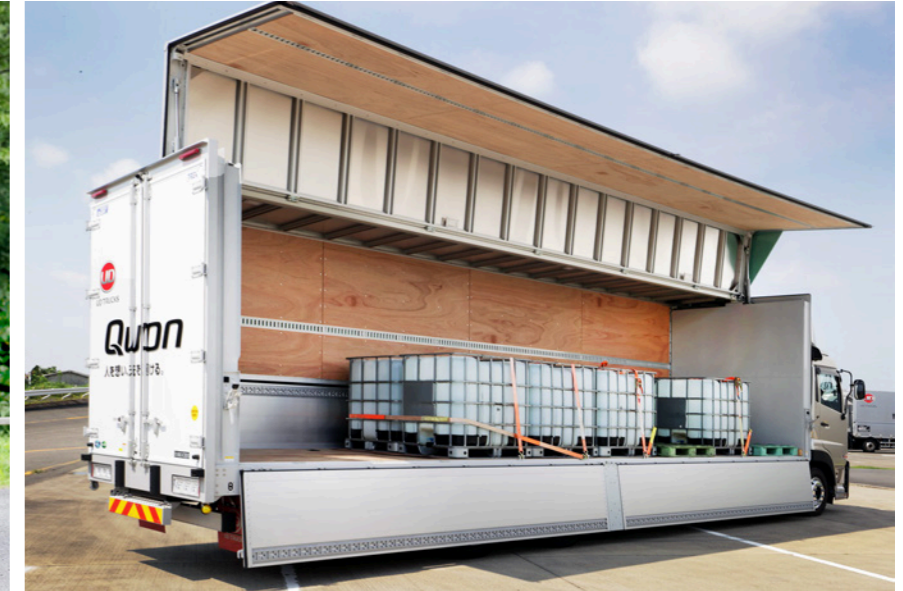
▲ ドライウイング車。側面が大きく開くため積み下ろしがしやすいのが特徴
