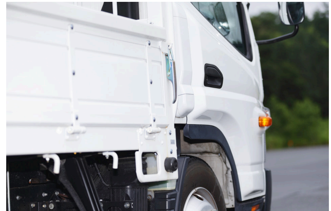
▲ 幅の広い荷台に合わせてキャブ幅段差を規定内に収めるためにキャブのドア部分を拡幅したトラック
