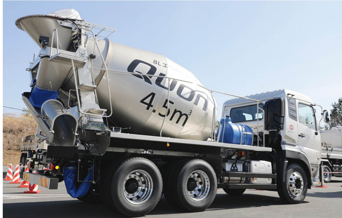
▲GVW20t級のミキサー車。ドラム駆動用の動力取り出し機構を備えた専用シャシーに架装されます
