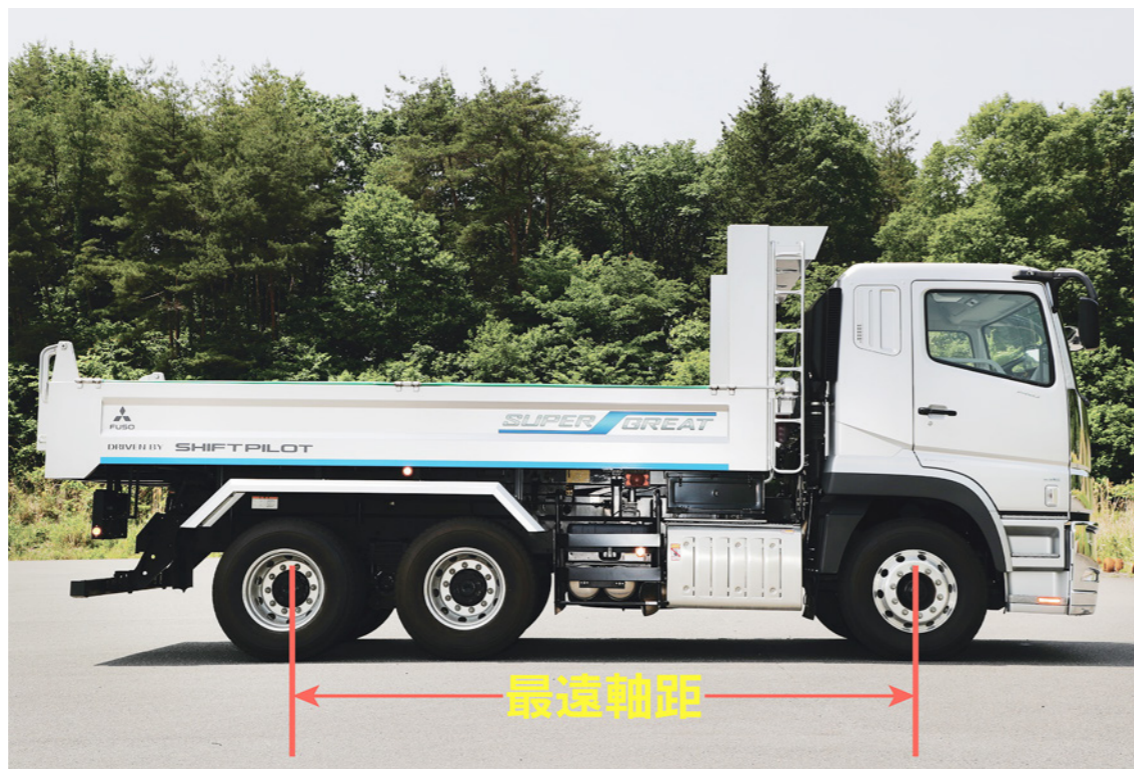
▲ 一番前の車軸から一番後ろの車軸までの間隔が最遠軸距
