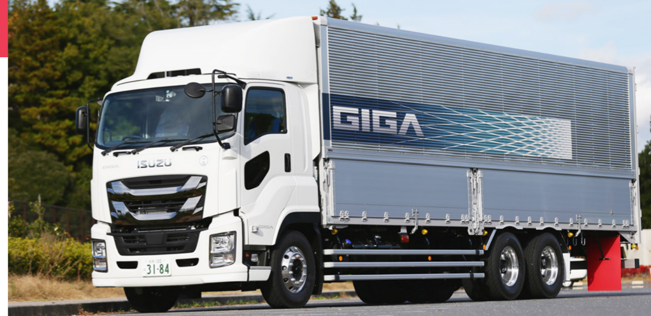
▲ 後2軸6×2駆動の単車車型
