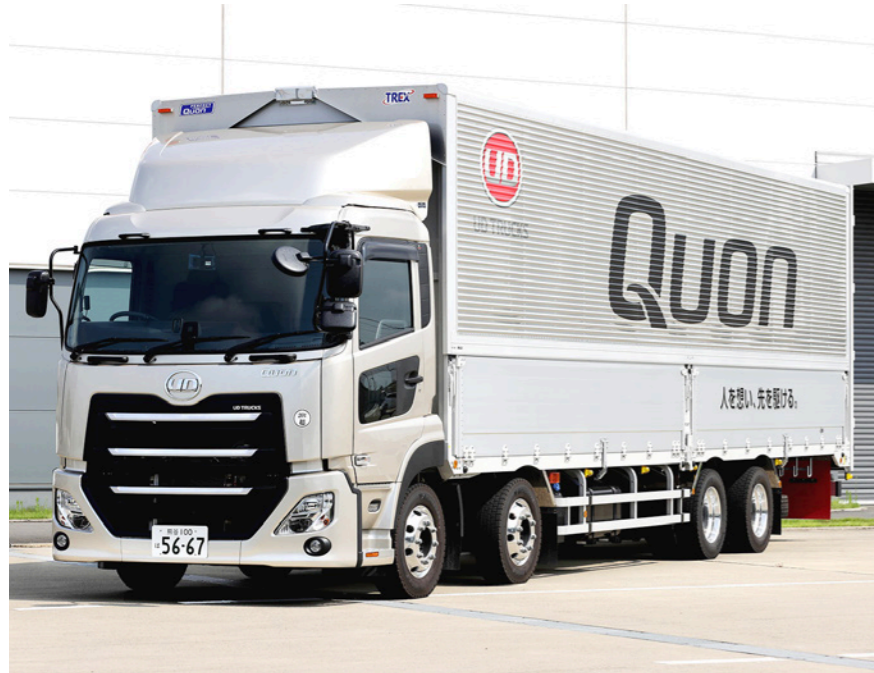
▲ 最大積載量で約13~14t、最も一般的なGVW25tの長尺カーゴ車
