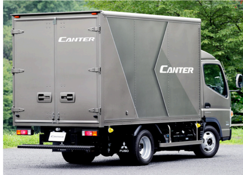
▲ 外板にアルミ材を使ったアルミバンは小型車に広く使われています
