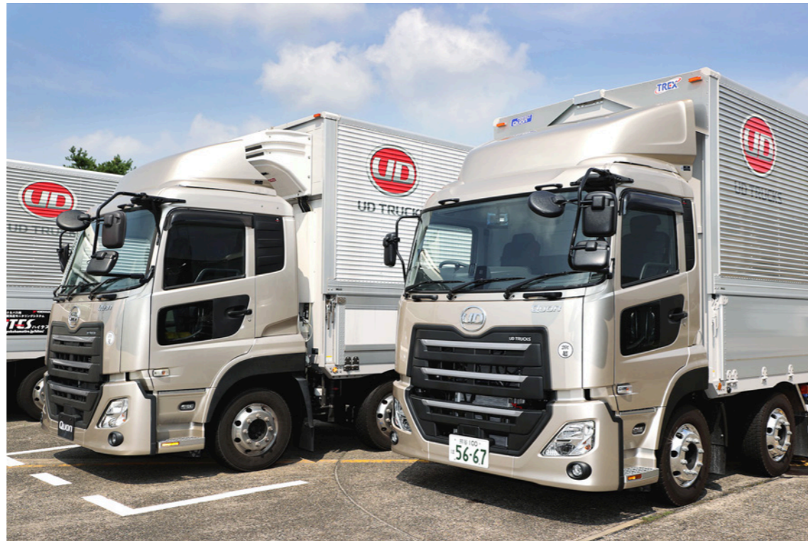
▲ 日本のトラックはキャブオーバー型が主流。奥側が大型のフルキャブ、手前がベッドスペースを省いたショートキャブ
