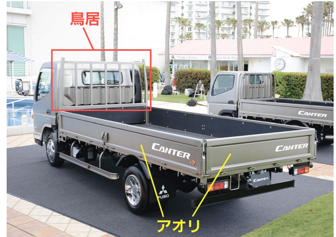
▲ 小型トラックの平ボディに使われている木製あおり。キャブと荷台の間の枠組みが鳥居
