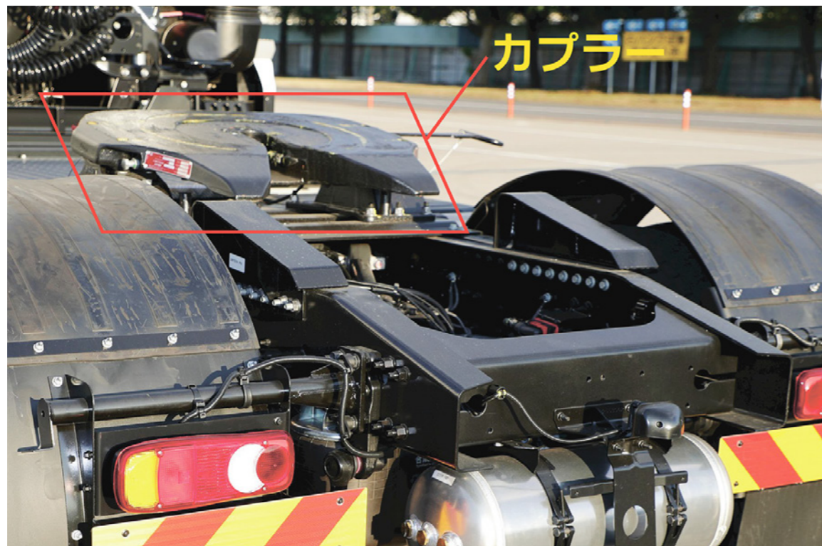
▲セミトラクターの連結用カプラー。上面でトレーラー側の荷重を受けます
